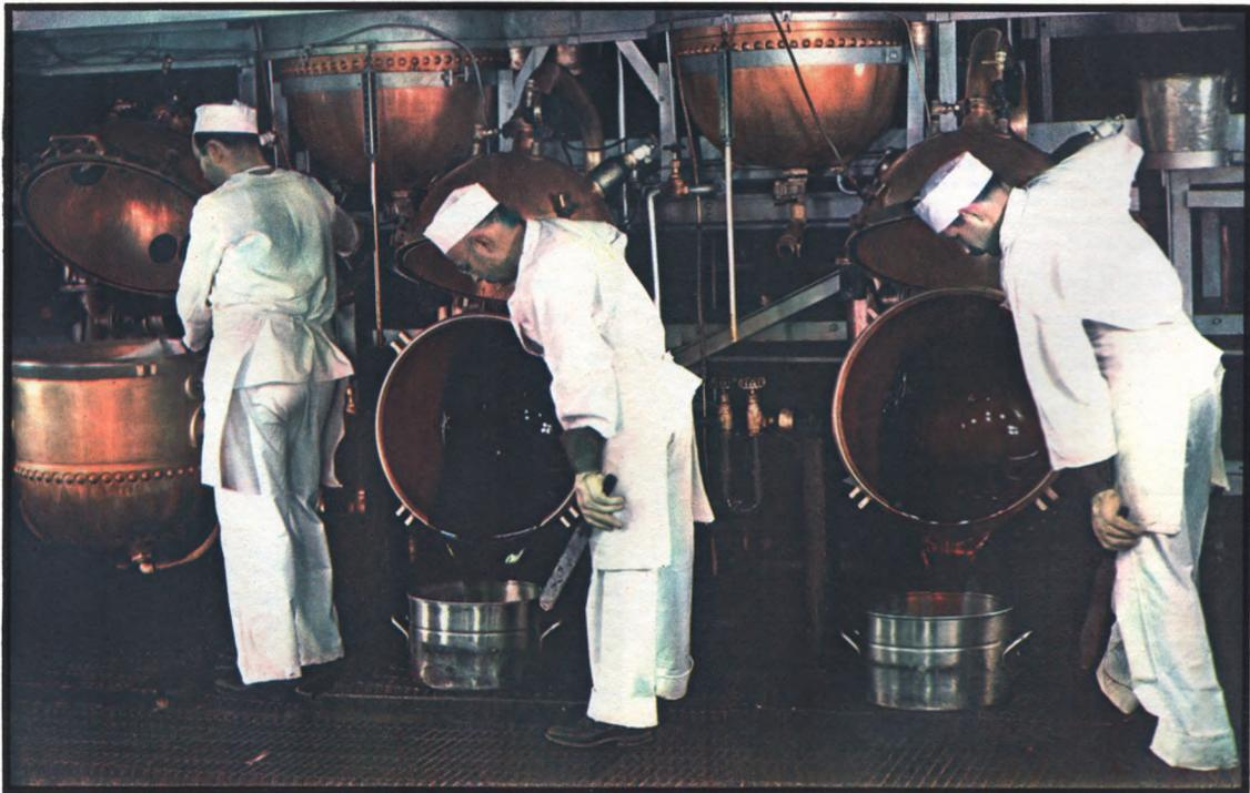
READY FOR THE COOLING SLAB: THE KETTLES COOK UP BATCHES FOR TWENTY DIFFERENT CANDY FLAVORS
